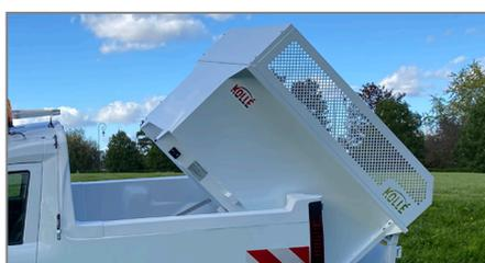
Rehausses tôle perforée avec rehausse arrière basculante
