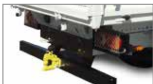
Attelage BTP Barre anti-encastrement renforcée avec feux sur perche et grille de feux
