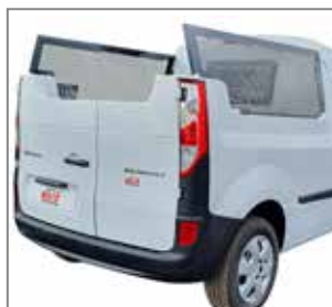
Rehausses latérales en tôle perforée
