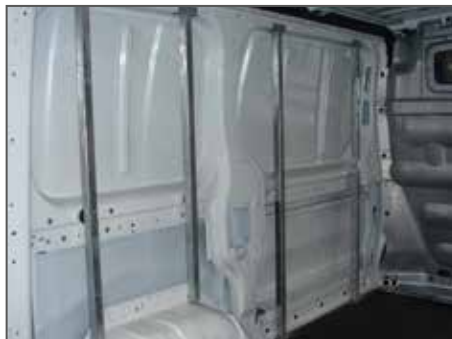
Ossature de renfort (avant pose de doublage)
