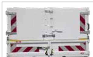
Rehausses arrière 2 vantaux avec dispositif ant-écartement renforcé.
