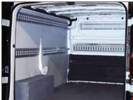
Doublage polypropylène + 2 rails parois et face avant
