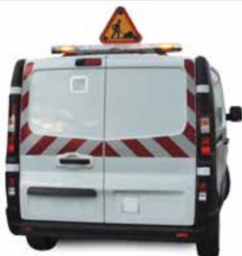
Rampe 2 Gyroleds + barre à défilement + triangle à LED
