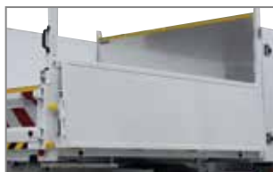
Rehausse latérale planche aluminium avec option plus-value version repliable
