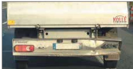
Pare-chocs arrière plus facilement abîmé, feux arrachés sur la version standard
