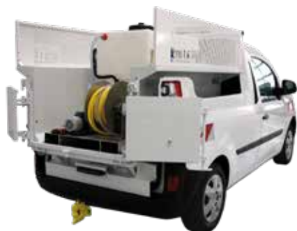
Kangoo pick-up benne basculante avec arroseur
