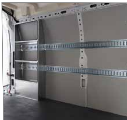
Doublage polypropylène avec plancher plastifié et rails
