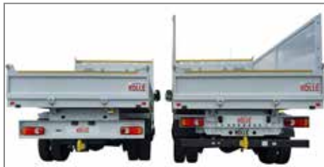
Comparatif attelage sous BAE d'origine VS attelage BTP avec feux sur perche
