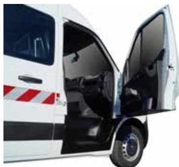
Découpe de porte passager avec modification d'emmarchement
