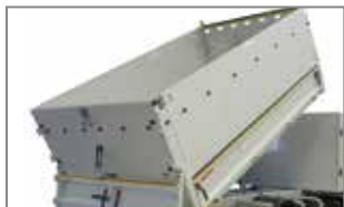
Rehausses latérales et arrière en tôle pleine aluminium
