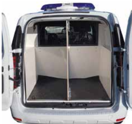
Aménagement maître chien
