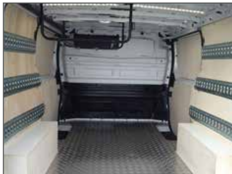
Doublage CP brut + 3 rails d'arrimage sur les parois
